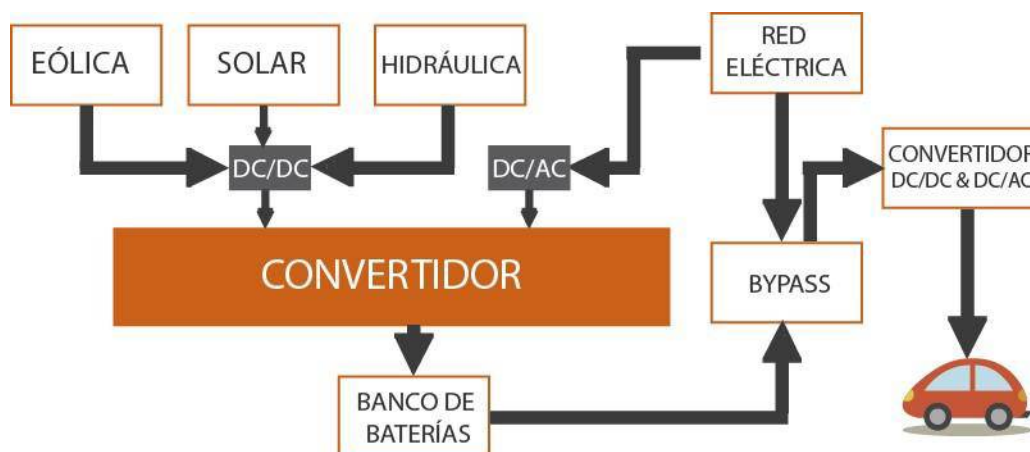
Figura 1, principio básico de una electrolinera
