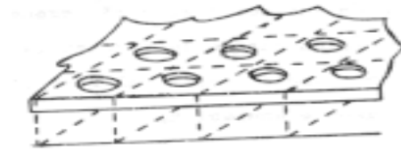
Figura 2.10. Conjunto de ressonadores feita a partir da perfuração de uma chapa
